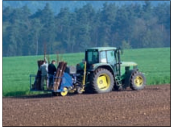
Abbildung 2.1.5: Steppplanter – Stecklingschnitt und Pflanzung in einem Arbeitsgang (Foto: HARTMANN)
